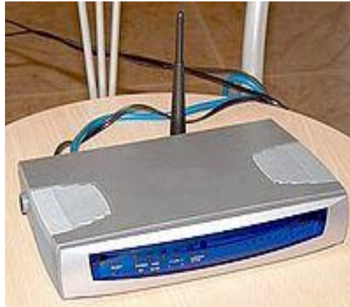
Figura 2.5 Punto de acceso inalámbrico 16
