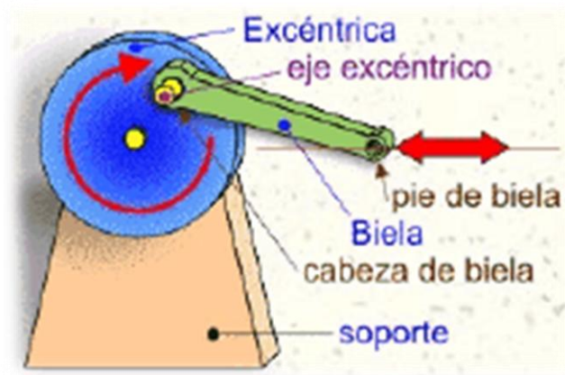
Figura 4.13 Mecanismo excéntrica – biela.
