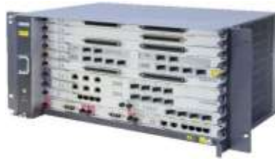
Gráfico N 22.- Constitución física de un OLT
