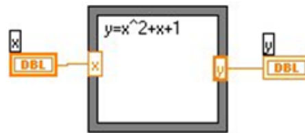
Figura N°: 6.20. Estructura “Formula Node” Fuente: El Investigador
