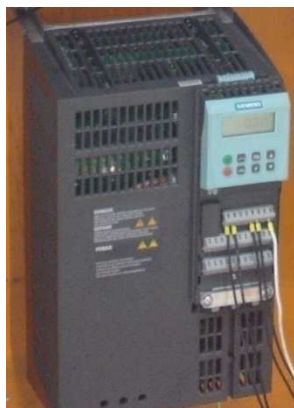
Ilustración 77: Variador de Frecuencia SINAMICS G120 (CU240E), (PM260), (BOP-2).
