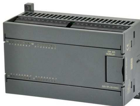
Ilustración 55: Módulo SIMATIC S7-200, MODULO E/S DIG. EM 223, 16 Entradas Digitales 24 V DC, 16 Salidas Digitales tipo Relés.
