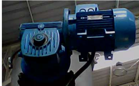
Ilustración 81: Motor del Torniquete de Giro de la Tela SIEMENS Modelo: 1LA7 113-6YA60.
