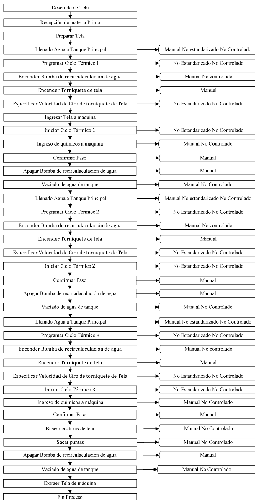
Ilustración 29: Diagrama de la situación actual de control de la máquina Over Flow 500.
