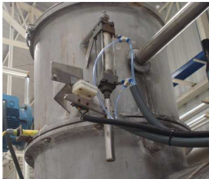
Ilustración 85: Mecanismo de Detección de Enredos en la Tela.
