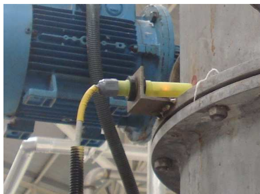
Ilustración 76: Detector de costura ELIAR Tipo S30.
