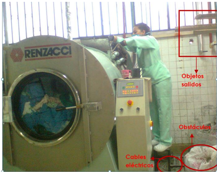
Fotografía No. 8: Trabajo en altura, colocando aditivos en lavadora en condiciones inseguras.
