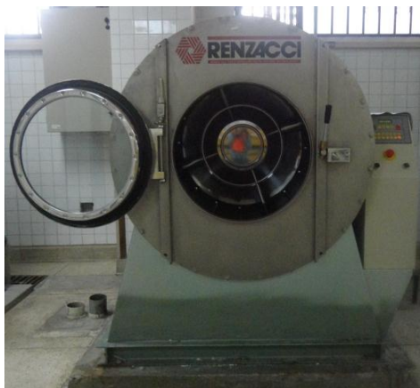
Fotografía No. 16: Lavadora Renzacci.
