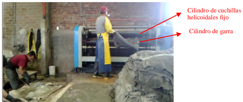
Figura N°24: Descarnado Fuente: Curtiduría Hidalgo
