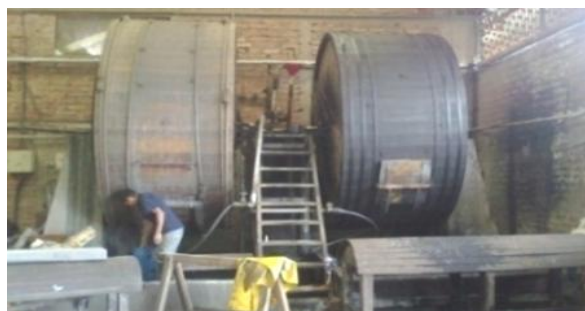
Figura N°29: Recurtido Fuente: Curtiduría Hidalgo
