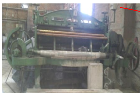
Figura N°74: Dividirora Fuente: Curtiduría Hidalgo
