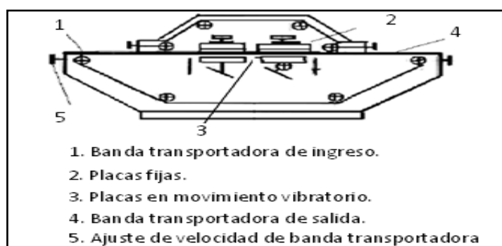
Figura N° 77: Partes de la Molliza.
