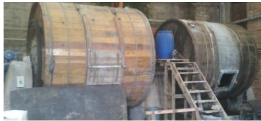
Figura N°26: Fulones de curtición Fuente: Curtiduría Hidalgo
