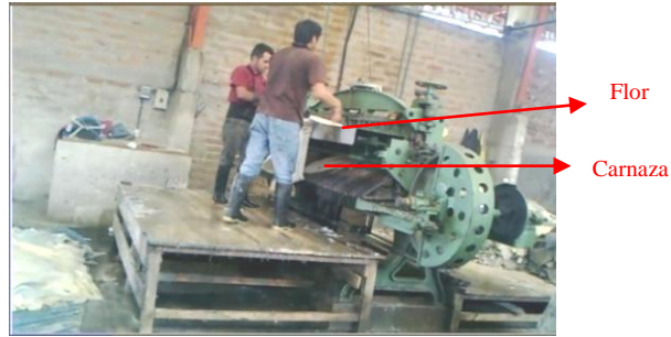
Figura N°25: Dividido Fuente: Curtiduría Hidalgo
