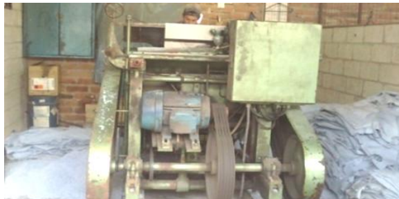
Figura N°28: Rebajado Fuente: Curtiduría Hidalgo
