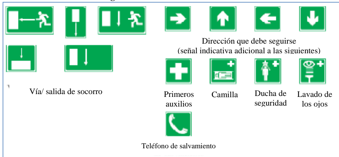
Figura 2.21: Señales de salvamento
