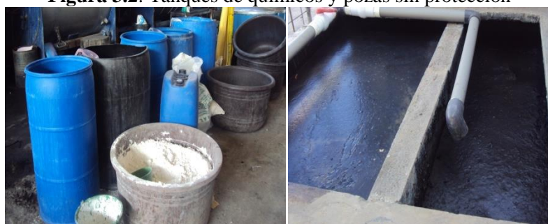
Figura 3.2: Tanques de químicos y pozas sin protección
