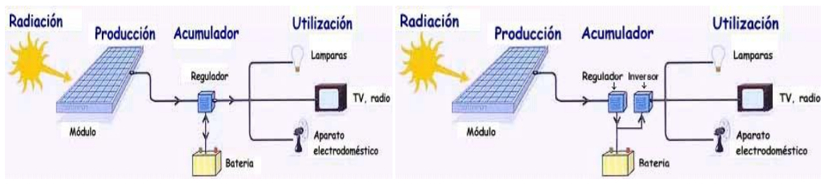
Instalación solar fotovoltaica sin inversor, a 12Vcc.
