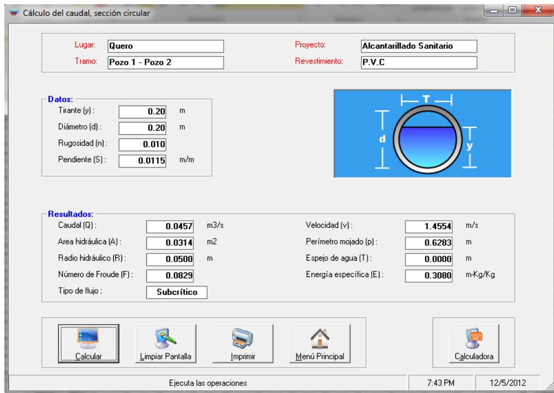
Gráfico VI.38. Caudal a tubería llena del tramo 1-2 con HCANALES
