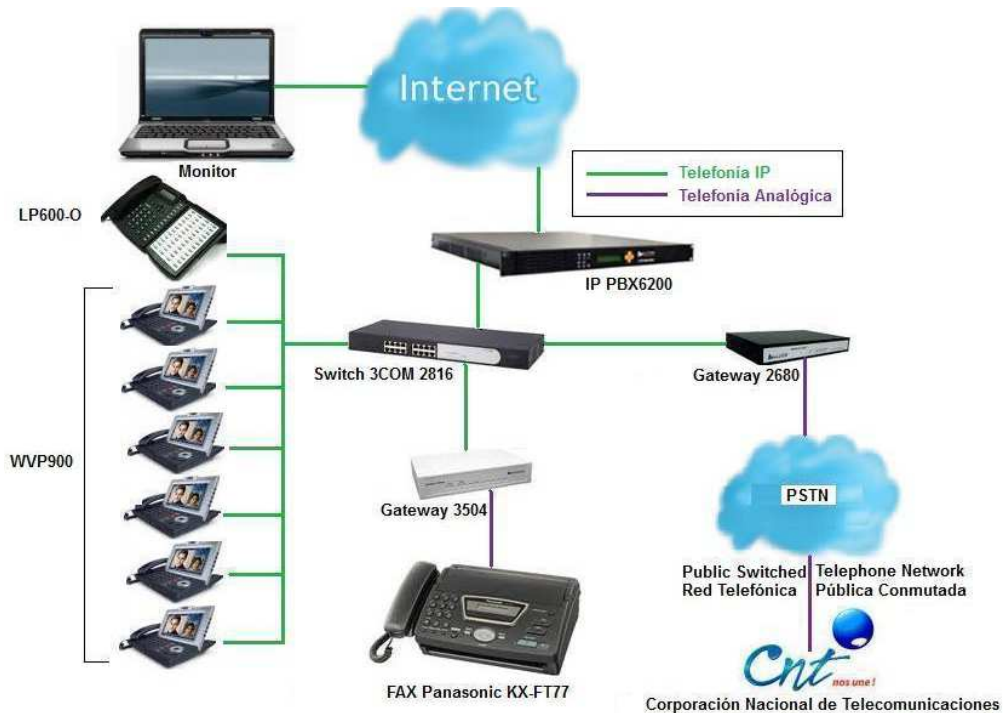
Gráfico Nº 33: Diseño de RED Elaborado por: Investigador
