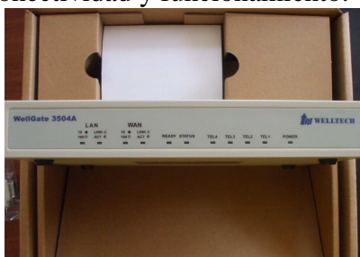
Foto # 15: Cara frontal Gateway 3504A Tomado por: Investigador
