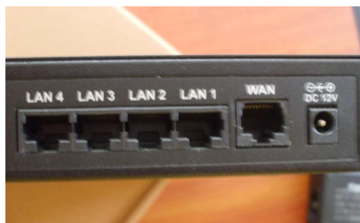
Foto # 12: Parte 2 cara posterior Gateway 2680 Tomado por: Investigador
