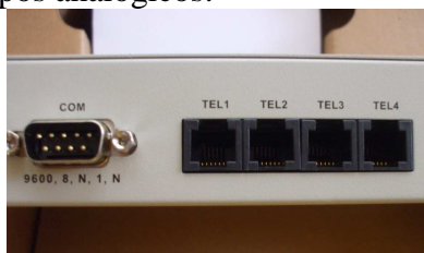
Foto # 17: Parte 2 cara posterior Gateway 3504A Tomado por: Investigador
