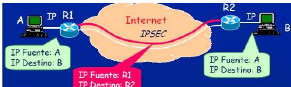
Figura No. 6.4: Comunicación segura limitada a los routers
