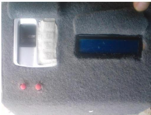
**Módulo Biométrico y LCD.**
