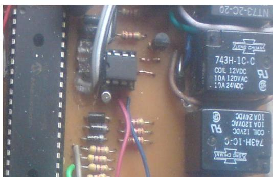
**Figura.6.19** Circuito de control de para los seguros eléctricos.
