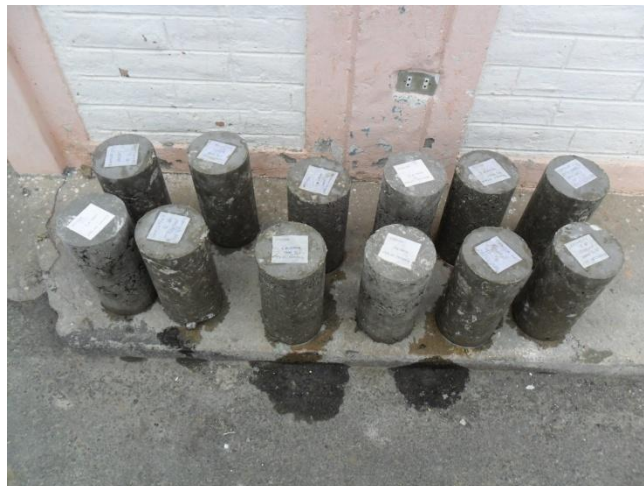
Imagen N°17.- Secado de las probetas de hormigón
