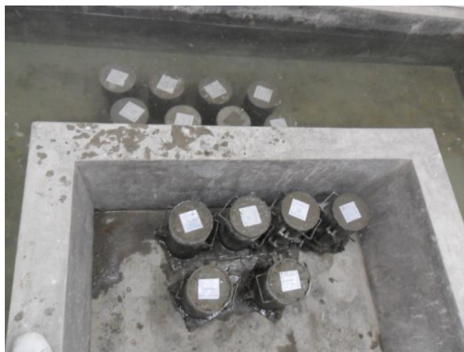
Imagen N°15.- Curado de las probetas de hormigón
