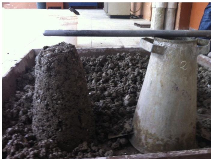
Imagen N°10.- Ensayo de consistencia de la muestra
