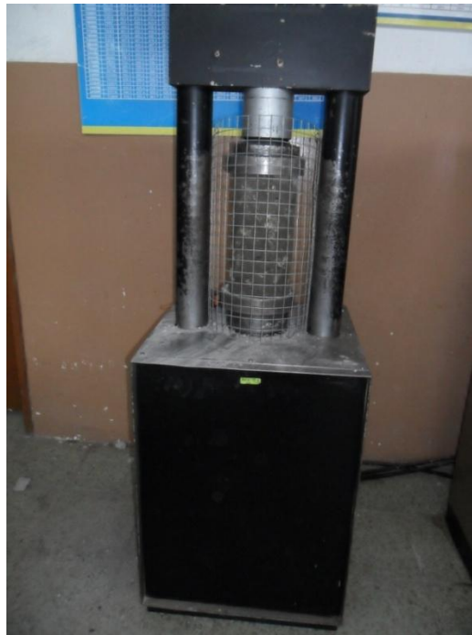
Imagen N°18.- Colocación de las probetas en la máquina de compresión
