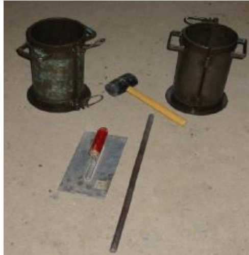
Gráfico N° 7.- Equipo para elaboración de cilindros
