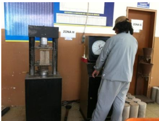
Imagen N°31.- Aplicación de carga sobre el bloque
