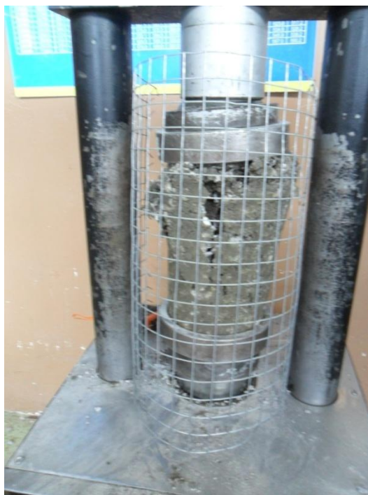
Imagen N°20.- Rotura de las probetas de hormigón
