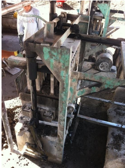
Imagen N°25.- Prensado de bloques
