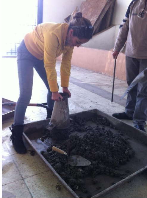
Imagen N°11.- Retiro del cono de Abrams verticalmente
