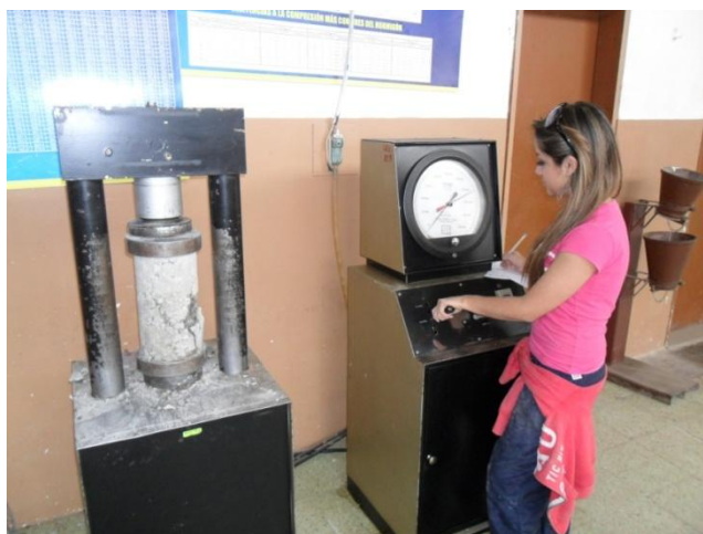
Imagen N°19.- Aplicación de carga a las probetas
