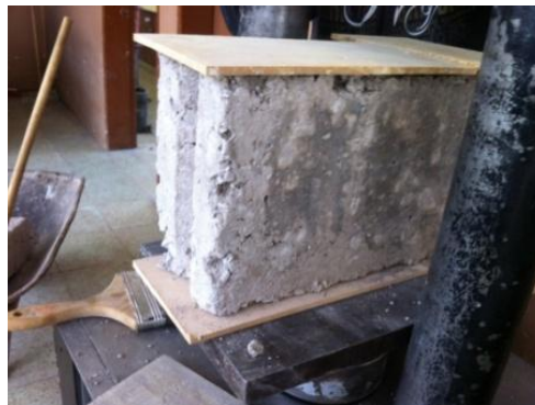
Imagen N°30.- Colocación del bloque en la máquina de compresión
