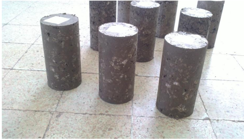
Imagen N°16.- Probetas de hormigón con la incorporación de papel
