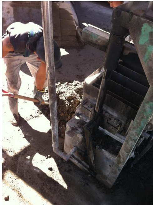
Imagen N°24.- Llenado de moldes en la máquina
