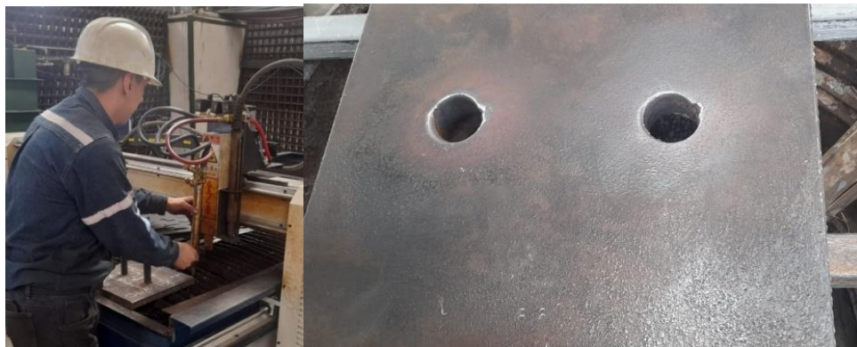
Figura 9. Corte de la placa base de 25 mm de espesor con la técnica de oxicorte
