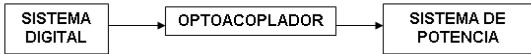
Fig. 6.17 Diagrama de bloques para interconexión de un sistema digital y un sistema de potencia.
