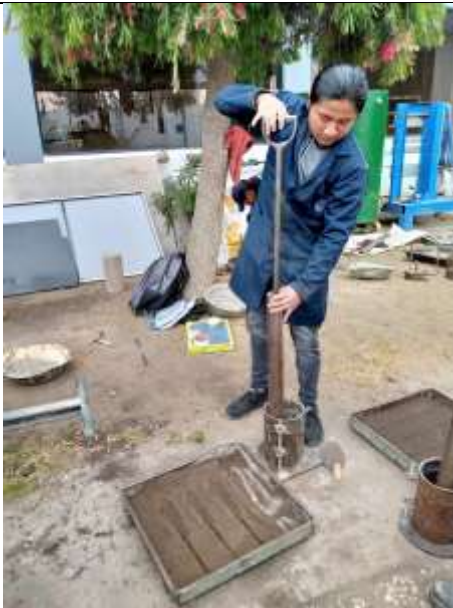
Compactación por capas
