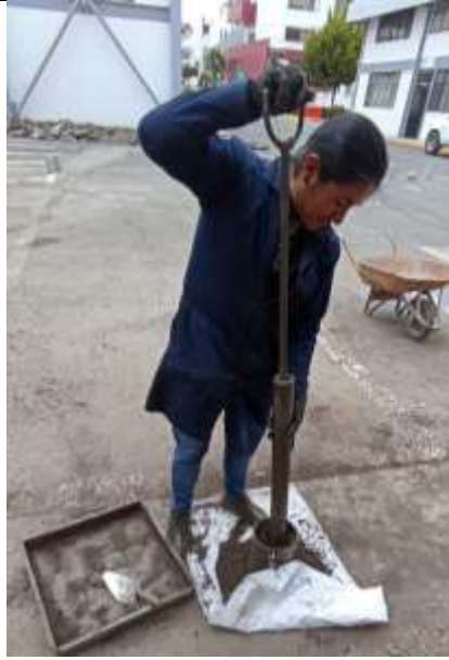
Compactación de la muestra por capas
