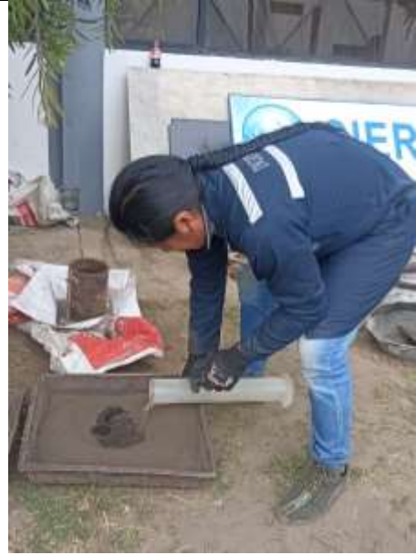
Colocación de humedad óptima
