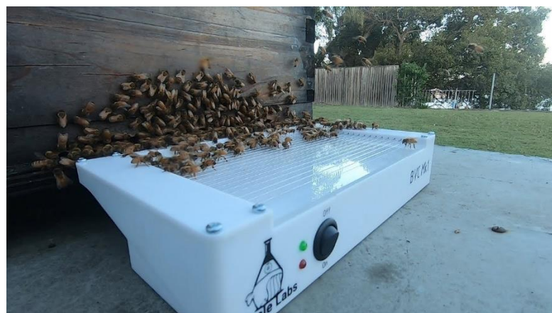
Figura 8. Colector eléctrico de api toxina con lamina de vidrio. [19]
