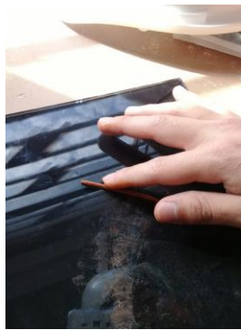
Fotografía N°15.- Ensayo de límite plástico con ayuda de placa de vidrio.
