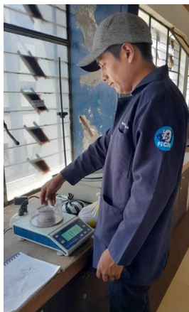
Figura N° 23.- Ensayo de contenido de humedad.
