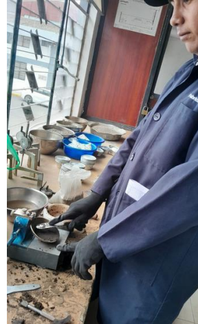
Fotografía N°14.- Ensayo de límite líquido con equipo de copa de Casagrande.
