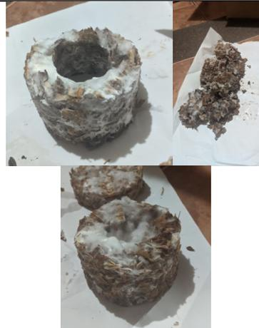
Después su etapa de secado se puede apreciar que el material es frágil al tacto, este se desarma con facilidad y el micelio está parcialmente desaparecido
