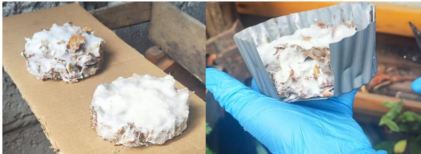
Despue de su etapa del secado se puede apreciar que el micelio no puede aglutinar el material totalmente. Lo cual provoco que este se desarme al secarse.
