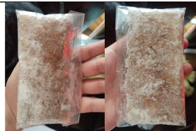
Después de 10 días de haber moldeado el micelio se abrió el molde y se pasó a secar afuera de la caja frente al foco de calor.
