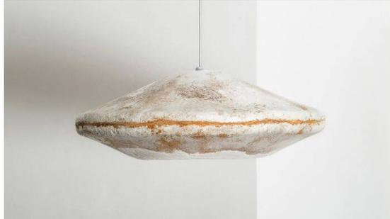
**Resumen:** Estas lámparas tienen un diámetro de 60 cm y utilizan material orgánico de desecho, como aserrín y paja, mezclado con micelio. El proceso de producción implica verter la mezcla en un molde, permitiendo que el micelio crezca y se adapte a la forma. Al actuar como aglutinante natural, no se requiere pegamento ni aditivos. La deshidratación posterior evita la expansión adicional del material, completando el proceso en aproximadamente cinco semanas.
