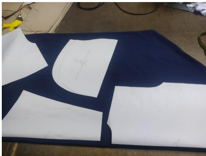
Figura 13. Colocación de molde de trazos
