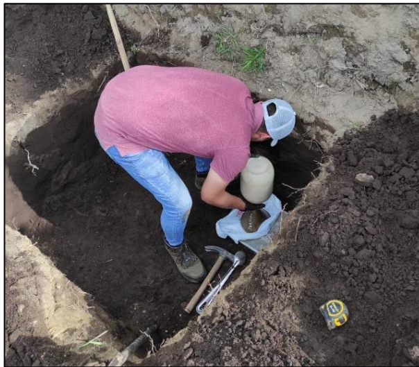
Fig 5: Utilización del Método Cono y arena Ottawa
