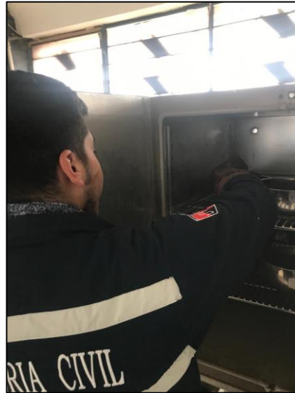
Fig 7: Colocación de muestras en el horno
