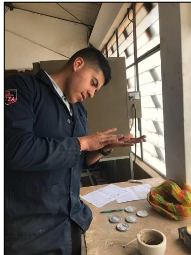
Fig 10: Ensayo del Límite Plástico
