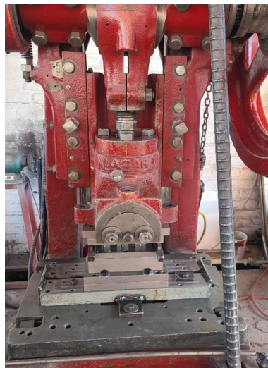
Figura 75. Ensamble conjunto armado de la matriz de corte para ángulo ranurado.
