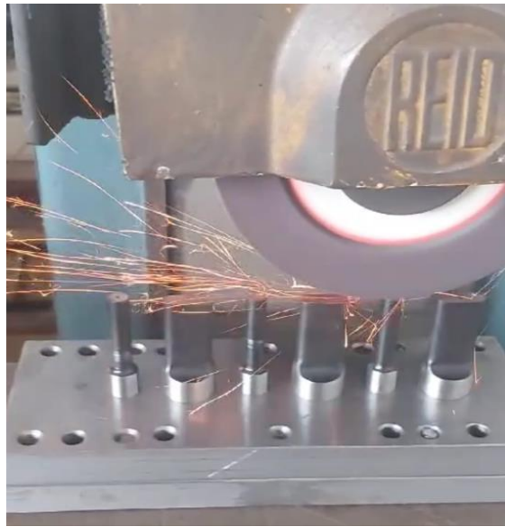
Figura 76. Rectificado de punzones post tratamiento térmico.
