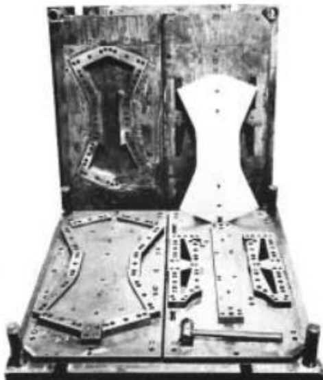
Herramienta de troquelar fabricada en acero Arne mecanizado de precisión.
