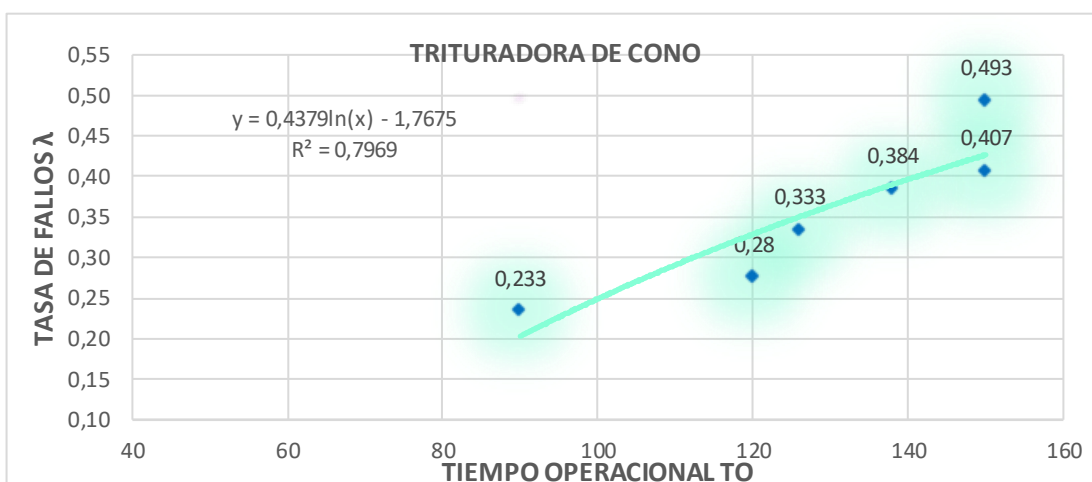
Figura 17. Tasa de fallos en función del tiempo operacional de la trituradora de cono. Ecuación logarítmica.
