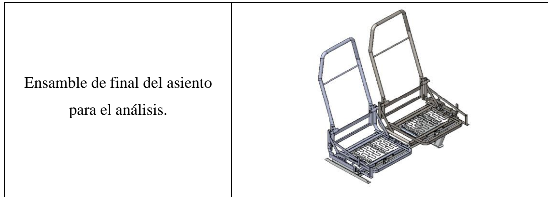
Figura 3.9. Diseño CAD de los componentes del asiento interprovincial, (Continuación).
