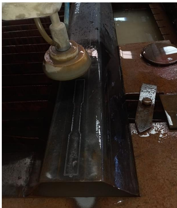
Figura 16. Proceso de corte por chorro de agua
