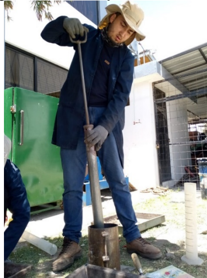
Figura 9. Ensayo Proctor modificado tipo B
