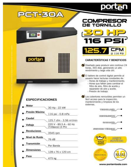
*Figura 2 Ficha Técnica Compresor de Tornillo Porten 30 HP [17]*
