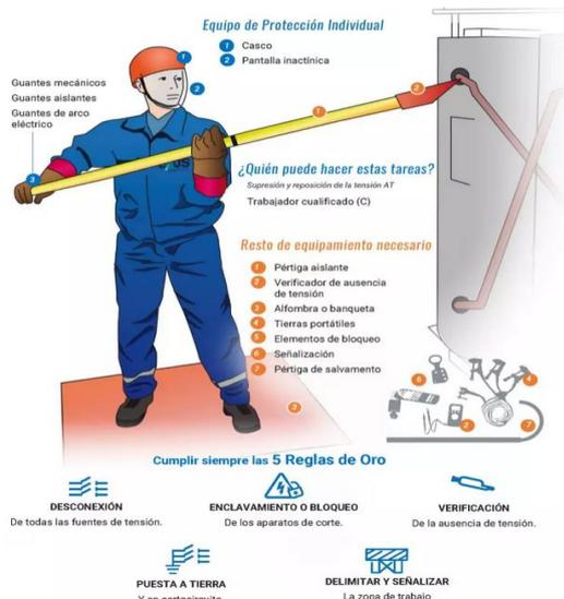
Figura 76. EPP's para los técnicos del área de pruebas eléctricas [65]
