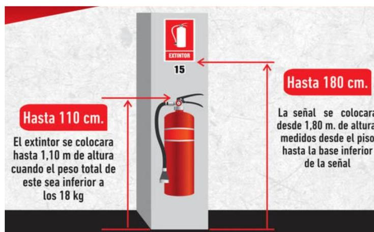
Figura 74. Altura de la instalación del extintor igual o menor a 18 kg [64]
