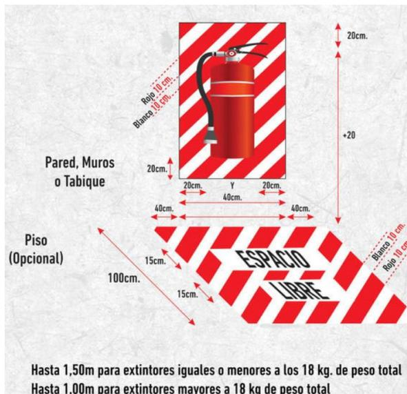
Figura 75. Dimensiones recomendables de la señalización para extintores [64]
