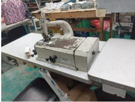
Figura 21. Maquina destalladora
