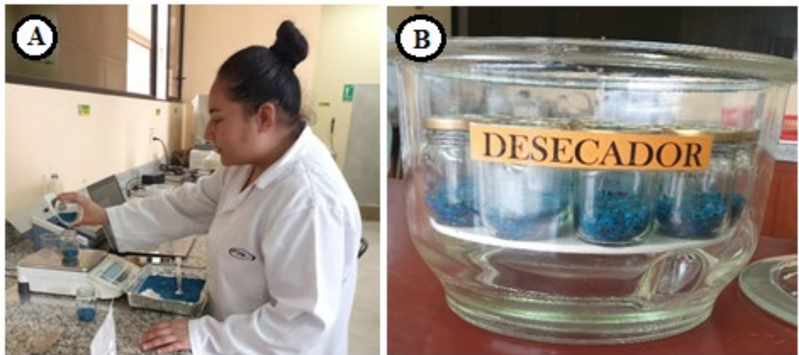
Anexo 6. Proceso de análisis de permeabilidad de los bioplásticos; A: Pesado del gel de sílice; B: Muestras listas para el análisis. Elaborado por: María Belén Vargas V
