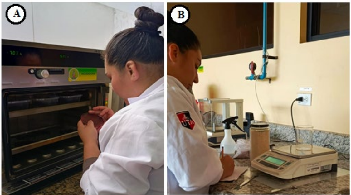
Anexo 5. Obtención de las muestras de bioplástico; A: verificación del proceso de secado; B: pesado de materia prima. Elaborado por: María Belén Vargas V.
