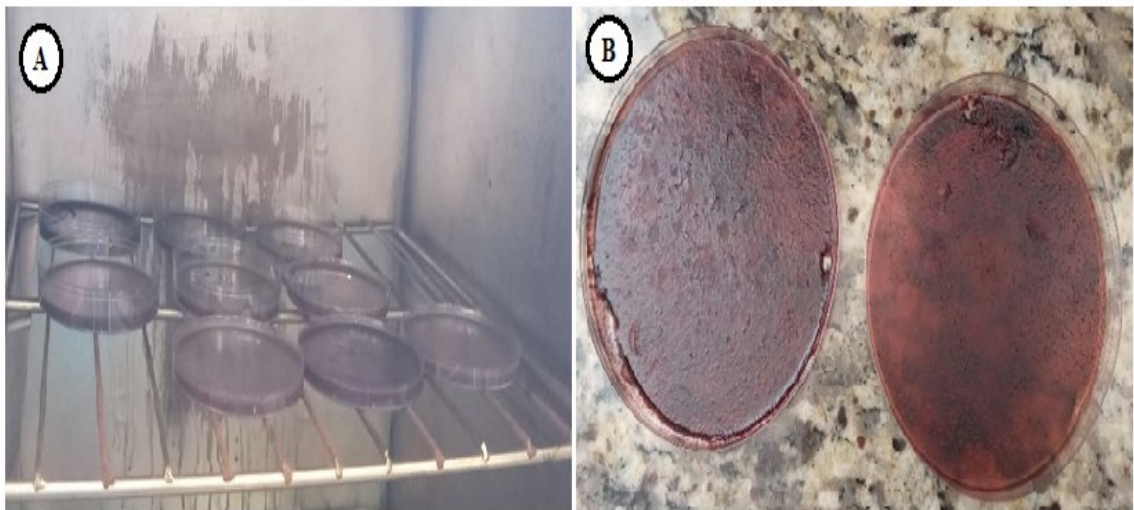
Anexo 4. Obtención de bioplásticos de harina de maíz negro (Zea mays L.) A: secado de los bioplásticos; B: bioplástico final listo para desmoldado. Elaborado por: María Belén Vargas V
