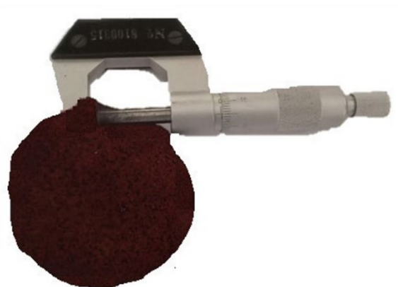
Figura 4. Análisis de espesor del bioplástico de harina de maíz negro ( Zea mays L. ) y glicerol. Elaborado por: María Belén Vargas V.
