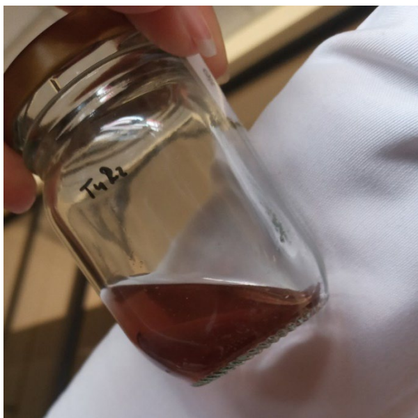
Anexo 7. Análisis de resistencia al agua de los bioplásticos de harina de maíz negro ( Zea mays L. ) y glicerol (Cambio de coloración del agua al caer la muestra dentro del recipiente). Elaborado por: María Belén Vargas V.
