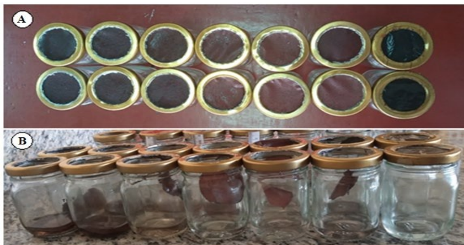
Figura 9. Análisis de resistencia al agua del bioplástico de harina de maíz negro ( Zea mays L.) y control; A: preparación de muestras iniciales; B: punto de rotura de los bioplásticos después de 48 horas. Elaborado por: María Belén Vargas V.
