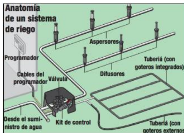
Figura 3. Funcionamiento de un sistema de riego automático [26].
