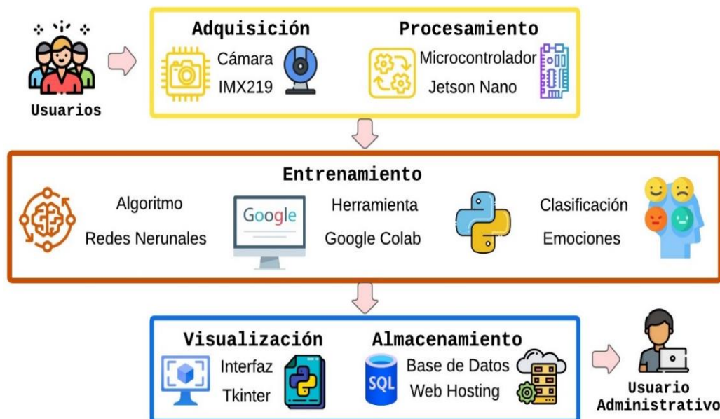
Figura 25. Arquitectura del sistema.
