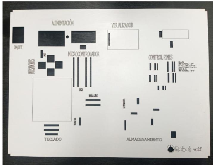
Figura 49. Corte finalizado en láser
