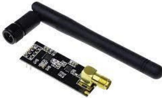
Figura 21. Módulo de NRF24L01 con antena [21]
