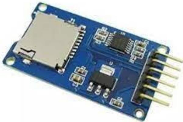
Figura 18. Módulo lector de tarjeta microSD [21]
