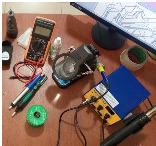
Figura 44. Kit de soldadura de PCB
