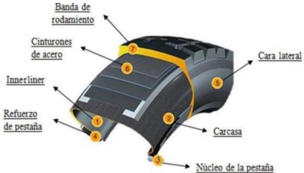
Figura 12. Partes de un neumático [42].
