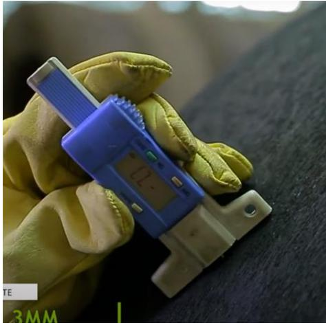
Figura 64. Verificación de profundidad del raspado
