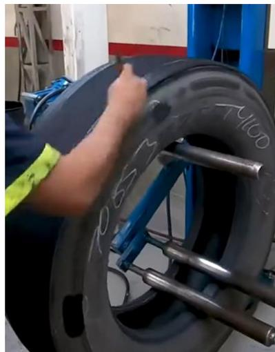
Figura 67. Aplicación del solvente de limpieza
