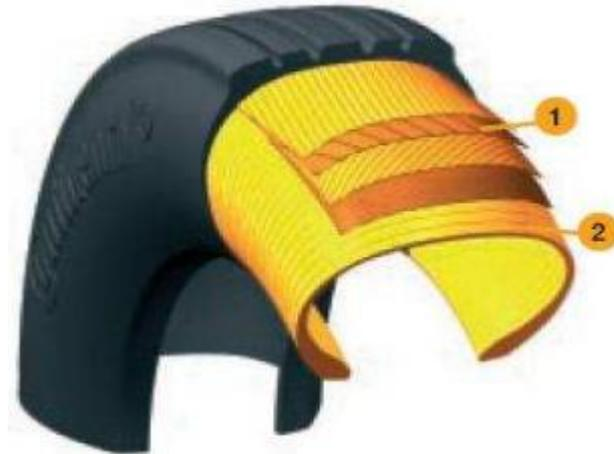
Figura 14. Construcción neumático radial [42].
