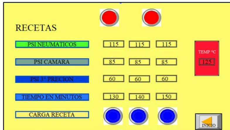
Figura 74. Control de los parámetros por HMI [53].
