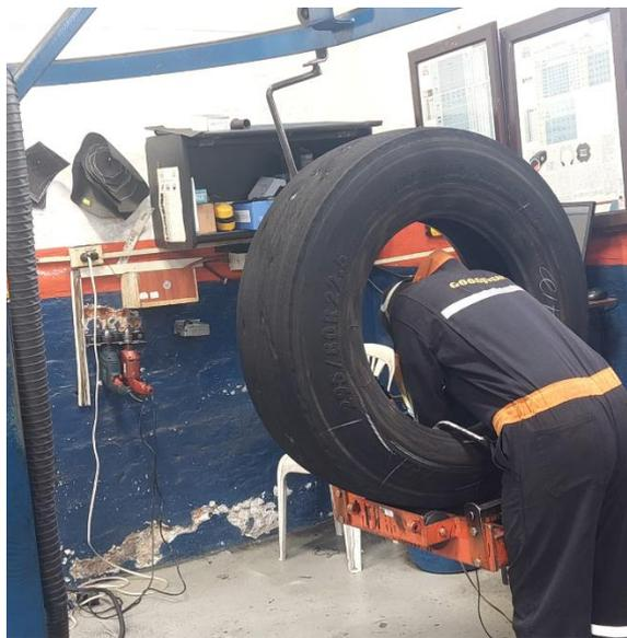
Figura 30. Inspección inicial del neumático.
