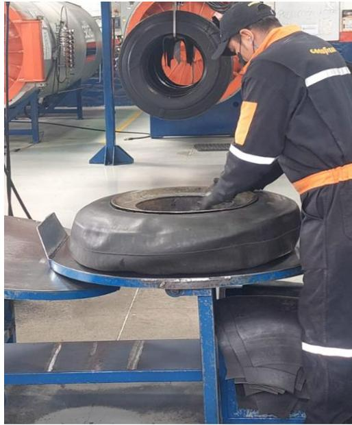
Figura 39. Armado del molde para el vulcanizado
