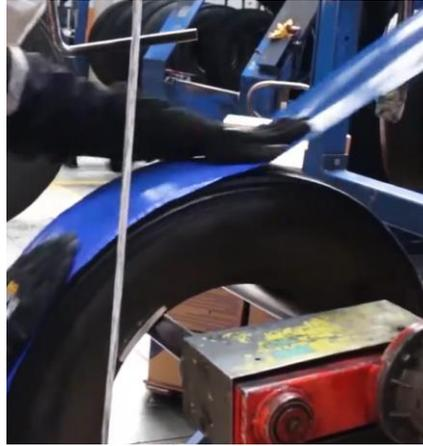
Figura 70. Aplicación de la película protectora
