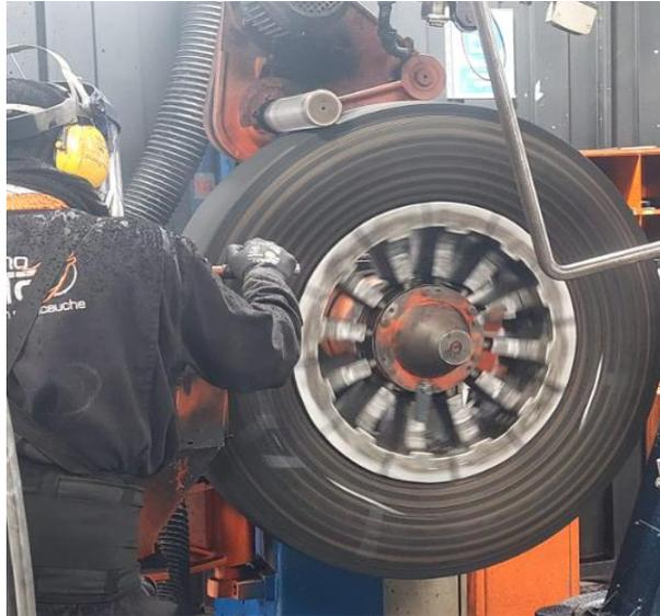
Figura 32. Área de raspado el neumático
