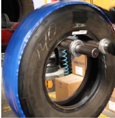
Figura 72. Inspección del recubrimiento
