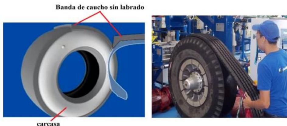
Figura 19. Colocación de la banda de rodamiento a la carcasa [42].
