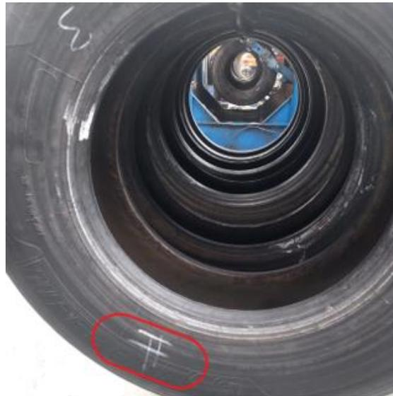
Figura 31. Neumático con simbología de daño.
