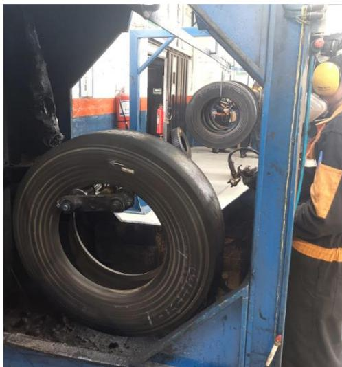
Figura 35. Aplicación del adhesivo en el neumático
