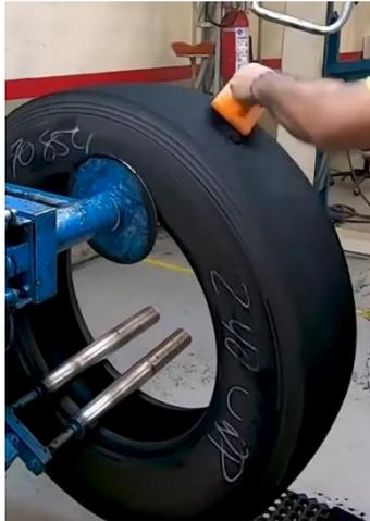
Figura 68. Limpieza de la superficie con el solvente
