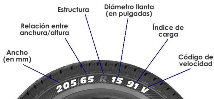
Figura 15. Significado de la nomenclatura del neumático [43].
