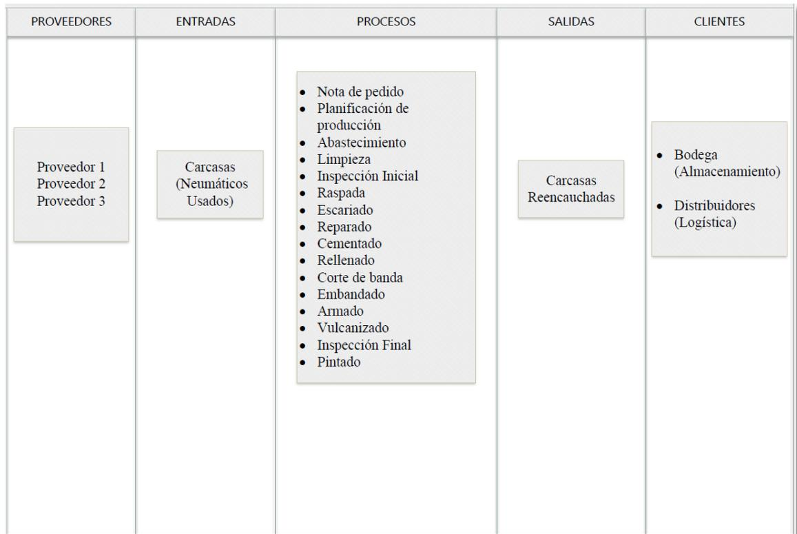
Figura 26. Diagrama SIPOC del proceso de Reencauche.
