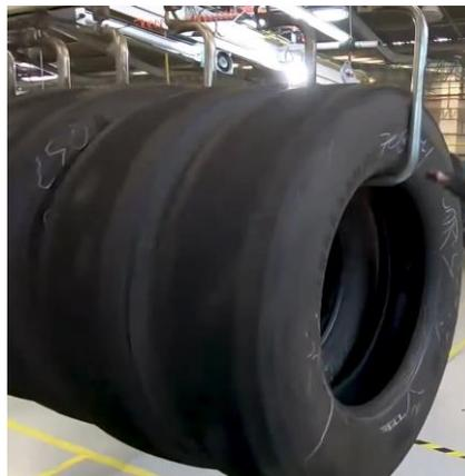
Figura 69. Carcasas suspendidas en el proceso
