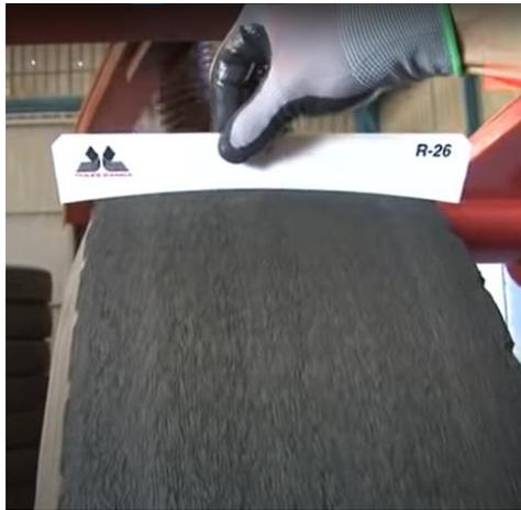
Figura 63. Plantilla de radio de raspado
