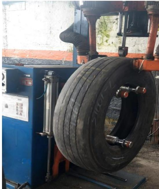
Figura 29. Limpieza del neumático.
