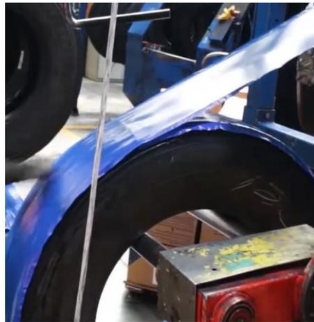
Figura 71. Forrado con la película protectora
