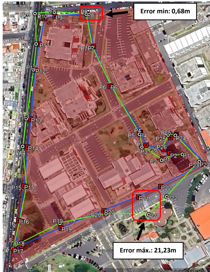
Figura 66. Diferencia mínima y máxima de distancia entre puntos del prototipo y GPS GLONASS del iPhone cada 30 segundos
