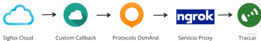
Figura 31. Diagrama de rastreo y localización.
