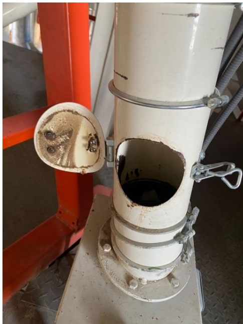
Figura 28. Suciedad en pasaje de trigo de acondicionamiento
