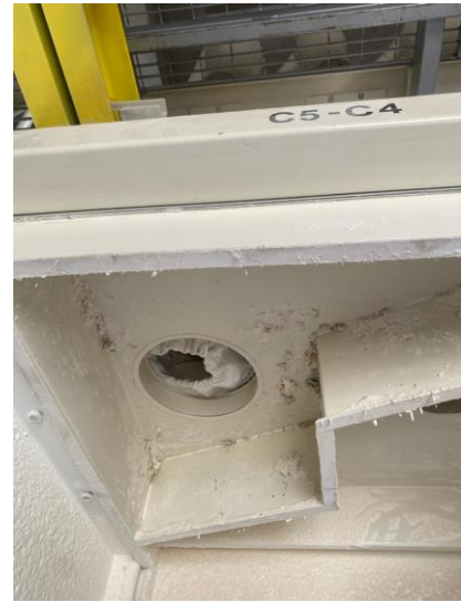
Figura 70. Presencia de plaga en mangas de plansifter
