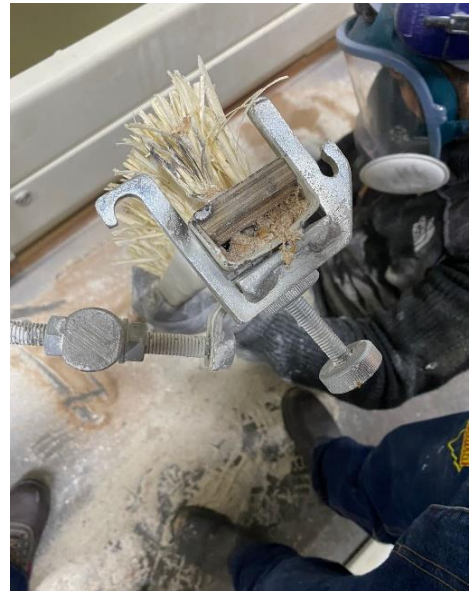
Figura 51. Precencia de pupas (huevos de mariposa) y suciedad en cepillo interno de bancos.
