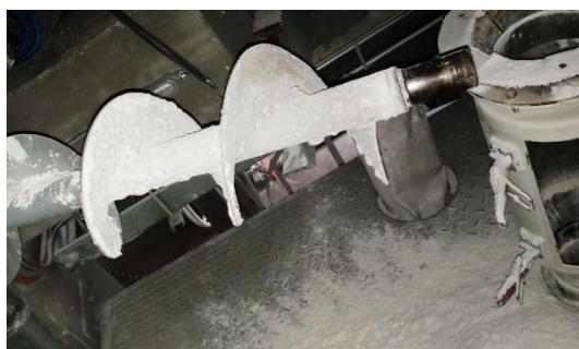
Figura 65. Presencia de suciedad en tornillo de harina (plaga)
