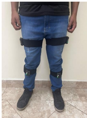
Figura 37. Colocación de acelerómetros en el sujeto de prueba.
