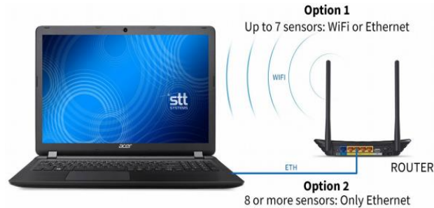
Figura 26. Conexión del equipo con el router [10].
