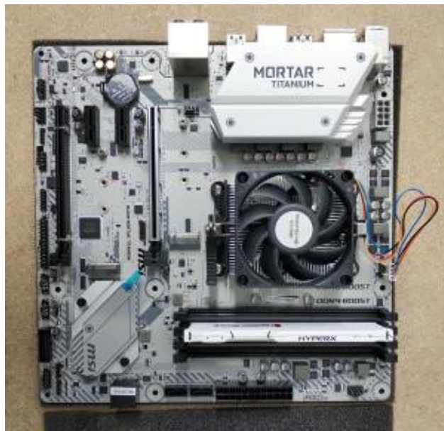
Figura 88. RAM y procesador instalado en la placa madre.
