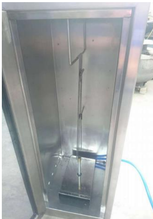
Figura 67. Mantenimiento de la cámara de inflamabilidad vertical [59].
