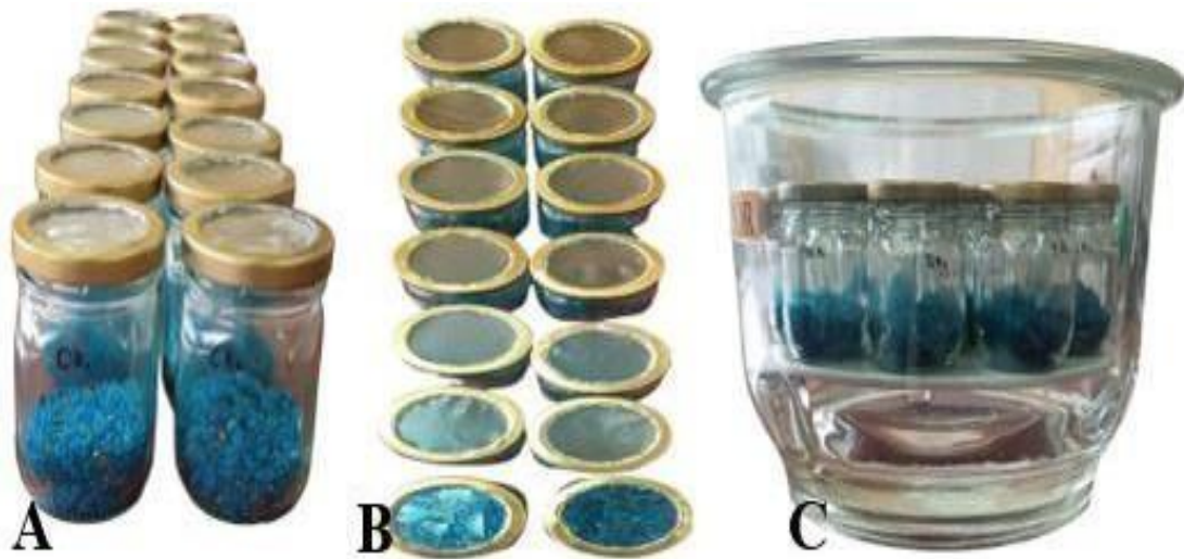
Figura 8. Análisis de permeabilidad al vapor de agua (PVA) en películas biodegradables a partir de harina de fruta de pan ( Artocarpus altilis ) y muestra control (PEBD). A: envases + sílica gel; B: biopelícula en envase; C: sistema completo en desecador con agua destilada (100%HR). Elaborado por: Galarza S. Inés
