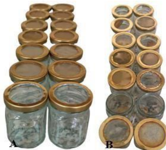
Figura 11. Resistencia al agua de películas biodegradables a partir de harina de fruta de pan ( Artocarpus altilis ) y muestra control (PEBD). A: inicio del proceso de resistencia; B: después de 48h los restos de las biopelículas degradables a partir de harina de fruta de pan ( Artocarpus altilis ) y glicerol. Elaborado por: Galarza S. Inés
