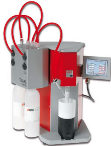
Figura 10. Equipo para medición de demanda de carga iónica
