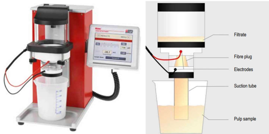
Figura 8. Equipo actual para medición de potencial zeta
