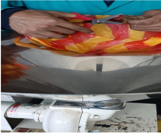
Figura A1. Trituración con molino eléctrico
