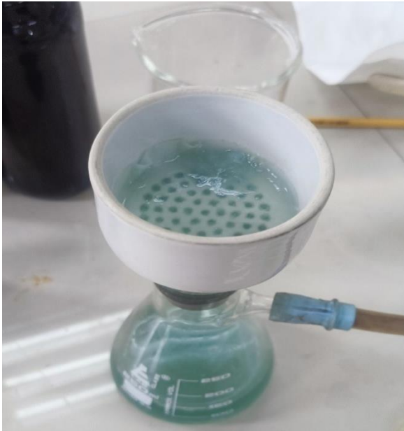
Figura A7. Filtración al vacío para eliminación de sólidos suspendidos
