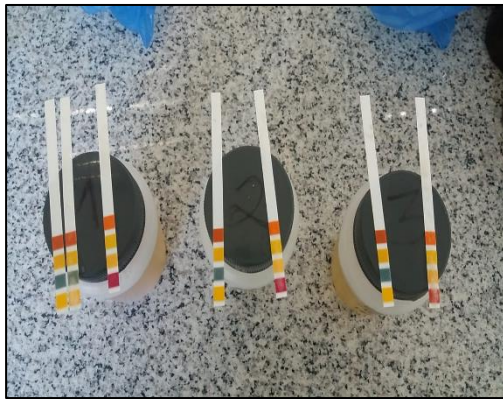
Evaluación del pH en orina antes y después de la adición de HCl
