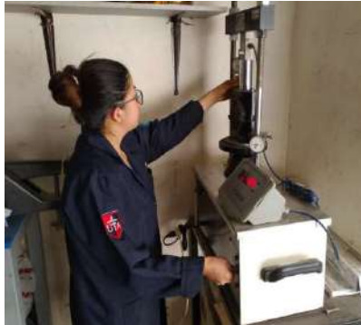
Ensayo de briquetas
