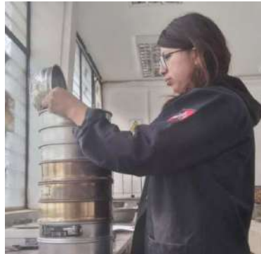
Gráfico N° 11. Ensayo granulométrico de los agregados.
