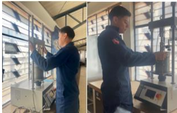
Figura N° 21.- Ensayando el CBR
