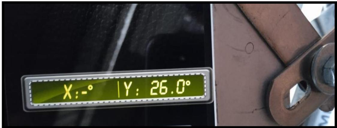
*Figura 2.4: Medición de ángulo con inclinómetro. [Autor]*
