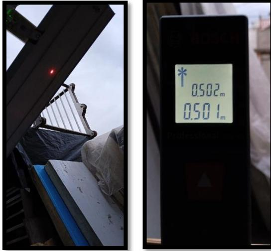
*Figura 2.23. Verificación de altura por medio de regla digital [Autor]*
