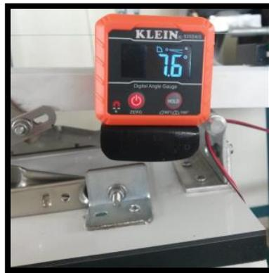
*Figura 2.21. Verificación del ángulo con inclinómetro [Autor]*
