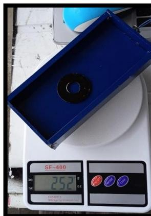
*Figura 2.19. Masa del móvil con peso adicional [Autor]*
