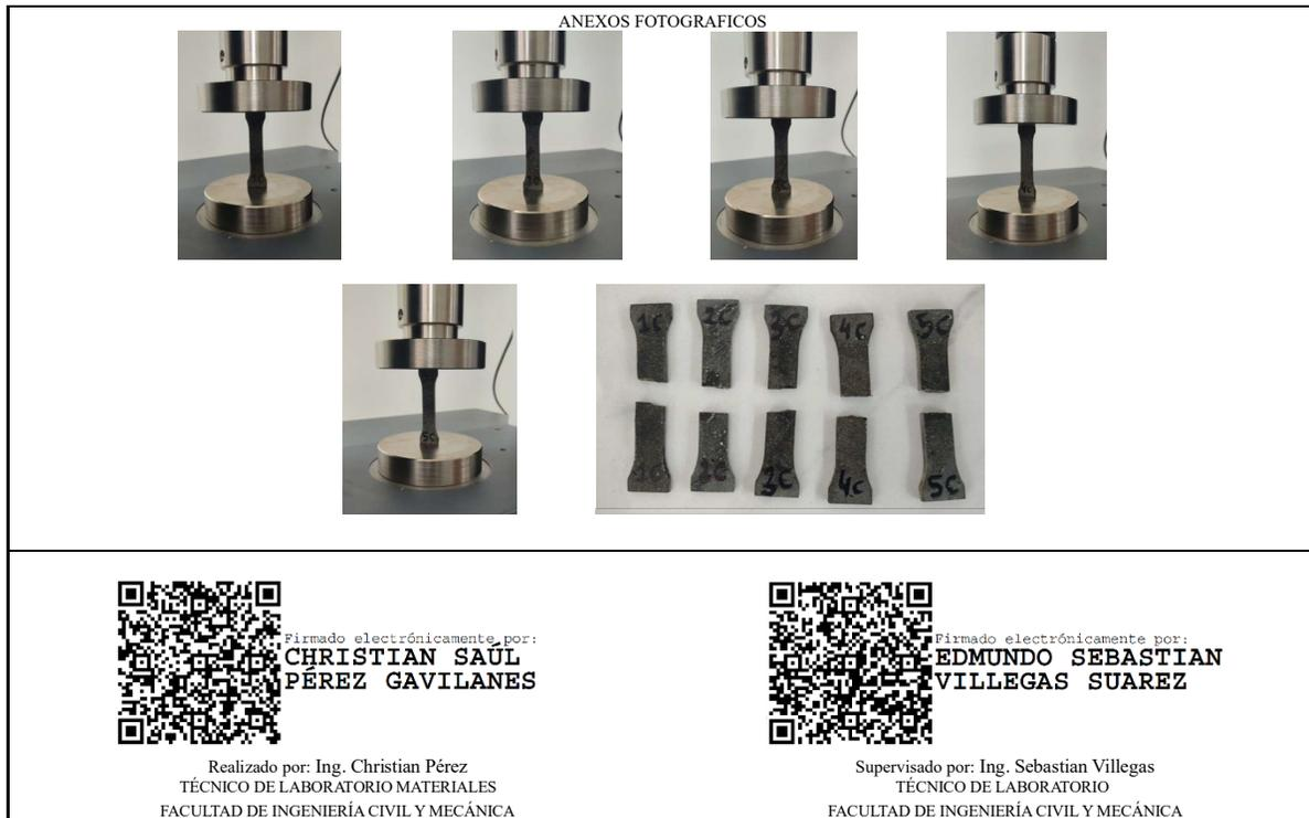
Para llevar a cabo el ensayo, se preparó una muestra de forma prismática. La muestra se coloca entre las placas de compresión de una máquina universal de ensayos, la cual aplica una fuerza gradual y constante en dirección opuesta hasta que la muestra se deforme o rompa.
