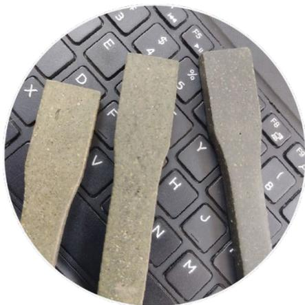
**Ilustración 26.** Muestras del compuesto polimérico.
