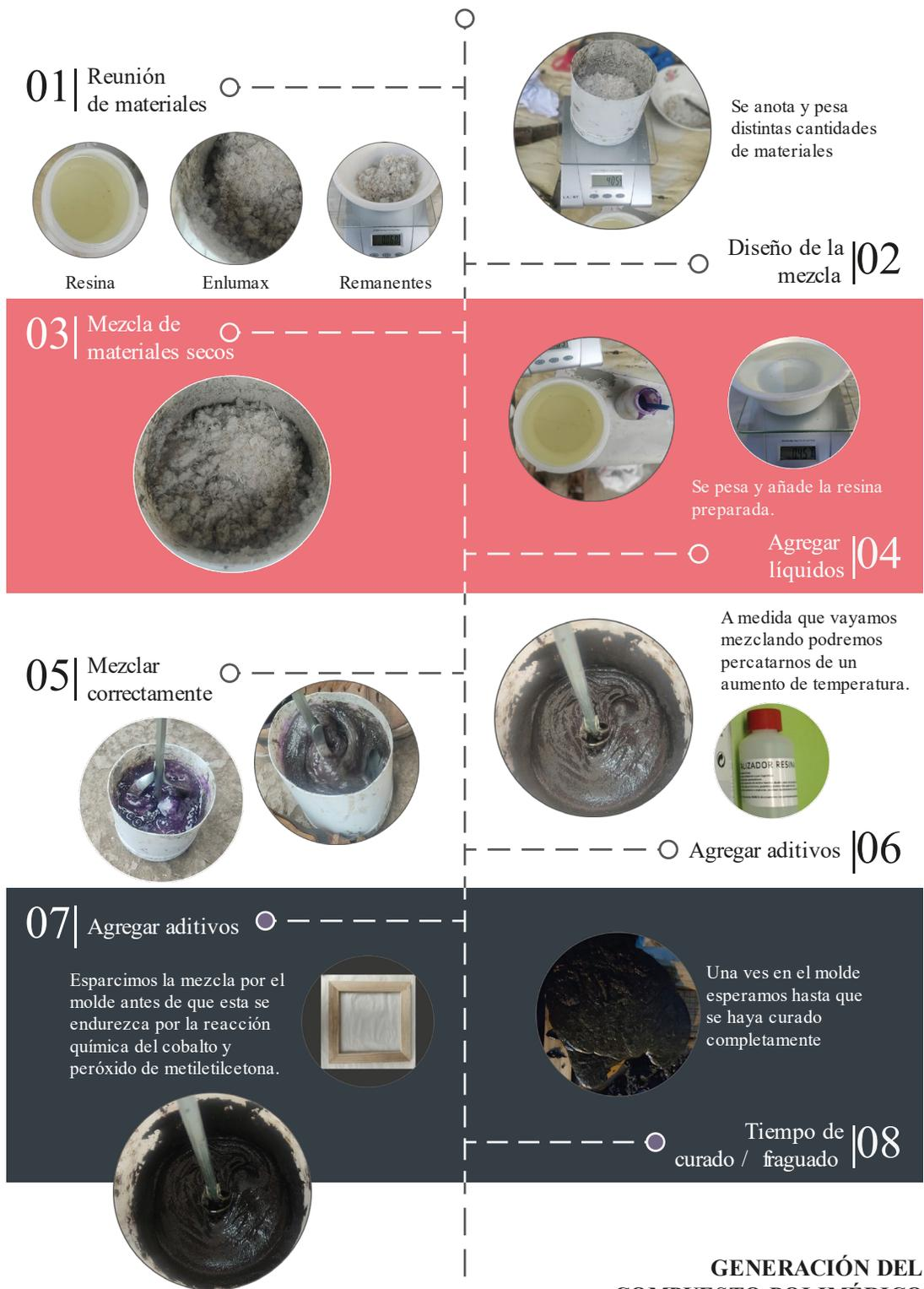
*Ilustración 25. Generación del material compuesto polimérico.
