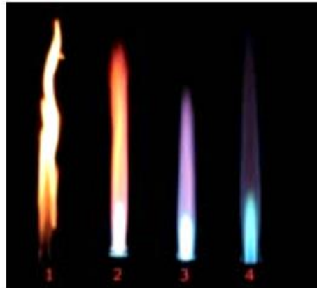
Figura 8. Tipos de flama en un mechero Bunsen dependiendo del flujo de aire
