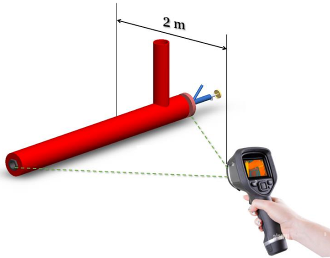
Figura 11. Ubicación de cámara termográfica
