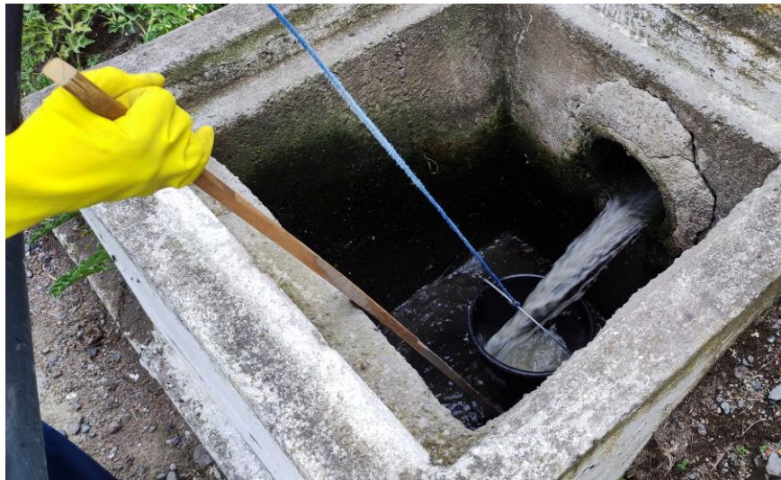
Figura 49. Medición de caudales mediante el método volumétrico en la caja de revisión de ingreso de agua residual. Fuente: Autor
