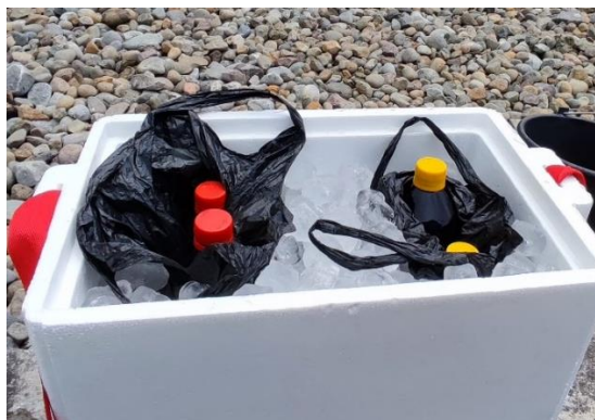
Figura 4. Muestras del agua a la entrada y salida de la PTAR conservadas en hielo.
