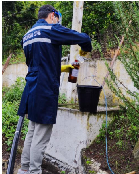
Figura 51. Recolección de alícuota para muestras compuestas en la caja de ingreso de agua residual de la PTAR. Fuente: Autor
