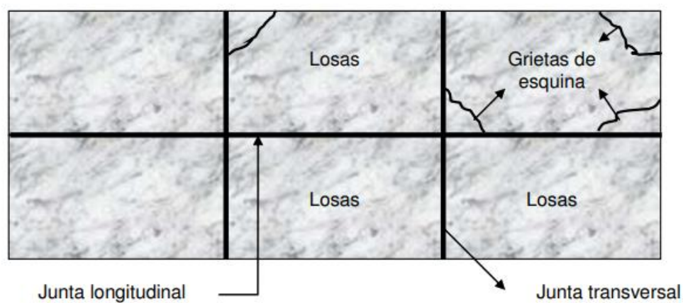
Gráfico 51: Agrietamiento de Esquina.
